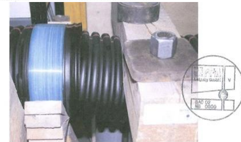
Bild 5: Ansicht der Rohrverbindung der angeformten Muffe während der Scherlasteintragung zum Ende der dreimonatigen Belastungszeit
