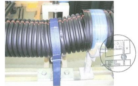
Bild 6: Prüfung der Wasserdichtheit mit Scherlasteintragung und Wasserinnendruck von 0,5 bar, die Verbindung mit Verformung war dicht
